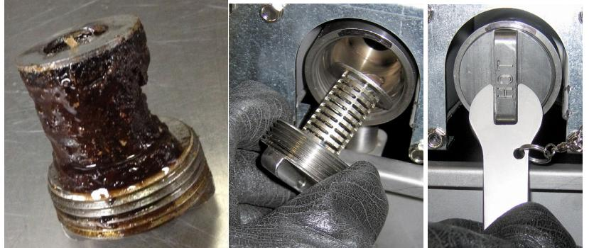
20. Utilice un destornillador para limpiar los desechos de las cavidades superiores de la sonda.
